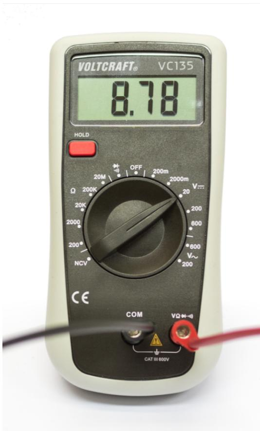
Abbildung 3: Multimeter zur Messung der Ausgangsspannung.
